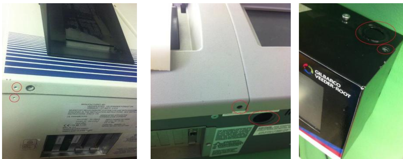
Рис. 13 Места пломбировки контроллеров TLS-350X серии 8470х, 8482х (слева), TLS-450X (по центру), TLS2X (справа)
