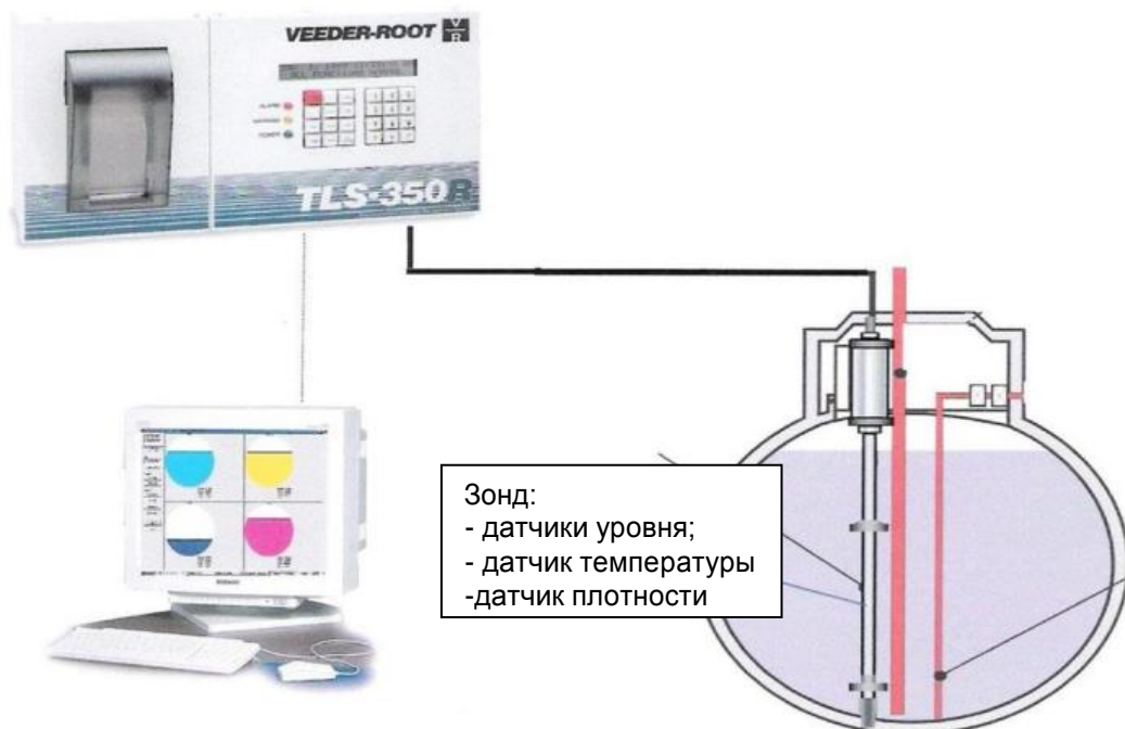
Рисунок 1 – схема Системы измерений массы нефтепродуктов VEEDER-ROOT для одного резервуара.
