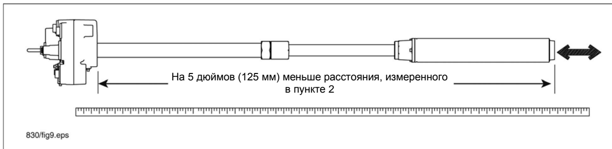
Рисунок 10. Регулировка длины насоса
