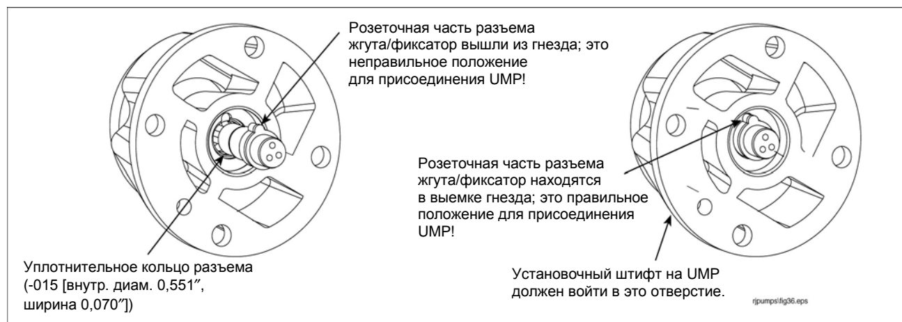
Рисунок 28. Проверка правильности положения розетки разъема жгута
